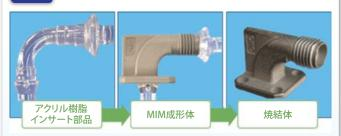
このワーク (SUS316L) は犠牲樹脂型を用いたMIM成形の手法により製作されています。内部にR形状のパイプを持つこのような部品は通常、機械加工で加工することが極めて困難であり、犠牲樹脂型を利用した、MIMの中でも特殊な手法でなければ加工できない形状と言えます。設計の可能性が広がる加工手法であると言えます。
