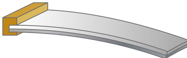
熱に反応するバイメタルの一例
